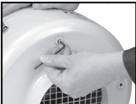
**步骤 1.** 卸下设备底座上的四个插入螺钉。
