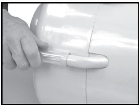
**步骤 7.** 安装回油管，并将管子定位，以便将油排回机器外壳、油底壳或收集容器。
