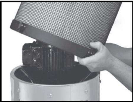
**步骤 4.** 检查后滤清器（如果已安装），必要时更换。
