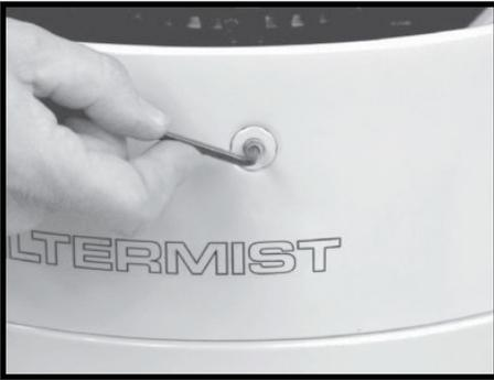
**第 1 步。** 以 90° 的间隔拆下设备顶部的四颗嵌入螺钉。
