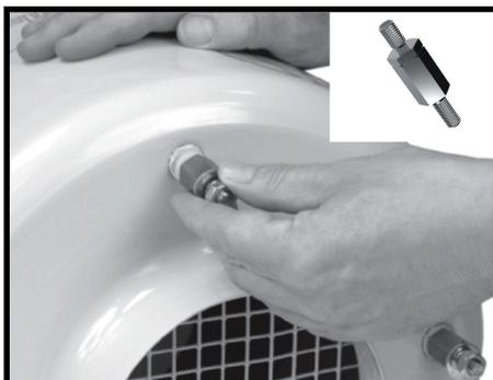
**步骤 2.** 安装四个箱体螺柱（随设备提供）。
