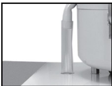
**第 4 步。** 安装回油管并放置导管，将机油排回机器外壳、油槽或收集容器。
