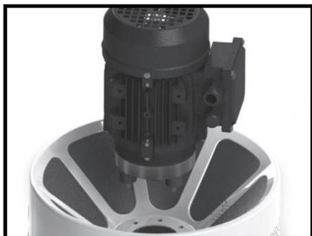
步骤 13. 将电机重新安装到机箱顶部。
