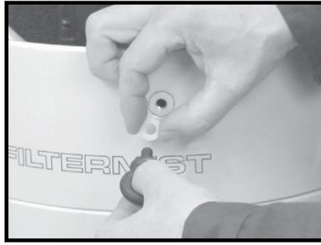
**第 2 步。** 用尼龙垫圈拧入四个吊环螺栓。
