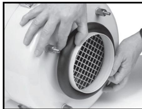
**步骤 3.** 在进水口周围装上泡沫密封圈（随设备提供）。
