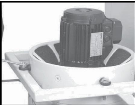
**第 4 步。** 在设备内部的吊环螺栓螺纹上安装安全螺母。
