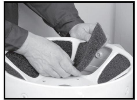
**步骤 12.** 拆下旧消音器，装上新消音器。
