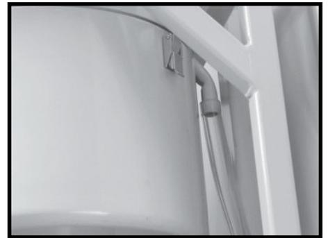
**第 6 步。** 使用合适的管道和适配器（单独提供）将装置的入口连接到排气孔。
