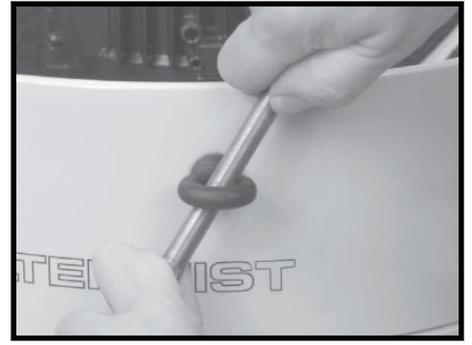
**第 3 步。** 拧紧吊环螺栓直至水平。
